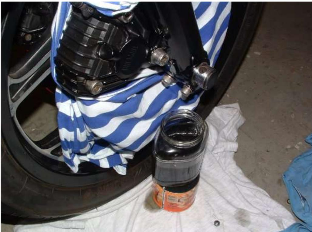
Jetzt die Ablass-Schraube mit neuem Dichtring wieder eindrehen (ca. 10 Nm). Gabelöl in vorgeschriebener Menge und Viskosität einfüllen (das geht am besten mit einer 80 – 100 ml Einwegspritze aus der Apotheke), Einfüll-Schraube mit neuem Dichtring wieder eindrehen (ca. 15 Nm).
