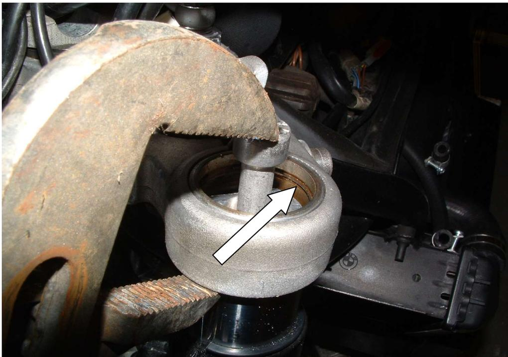
Dann Gabelverschluss-Stopfen mit der eingedrehten Schraube herausziehen. Zum herausziehen der mehrteiligen Feder und der Distanzhülsen haben sich verschieden lange Drahtthaken bewährt.
