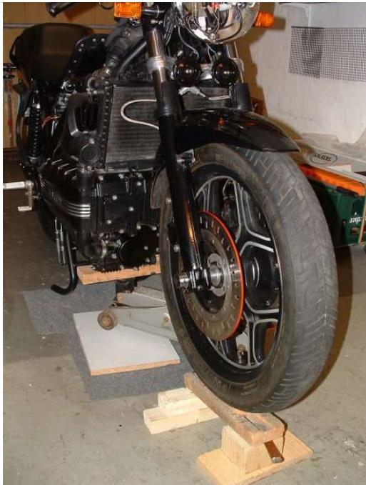
In meinem Fall empfiehlt die Fa. Wilbers **bei eingefederter Gabel** Öl bis 170 mm unterhalb der Standrohroberkante aufzufüllen. Da ich das Risiko nicht eingehen wollte, das Motorrad abzubocken schien es mir sinnvoller das Vorderrad soweit anzuheben, bis die Gabel ganz eingefedert ist. Dies lässt sich mit einigen Holzklötzen recht einfach bewerkstelligen.
