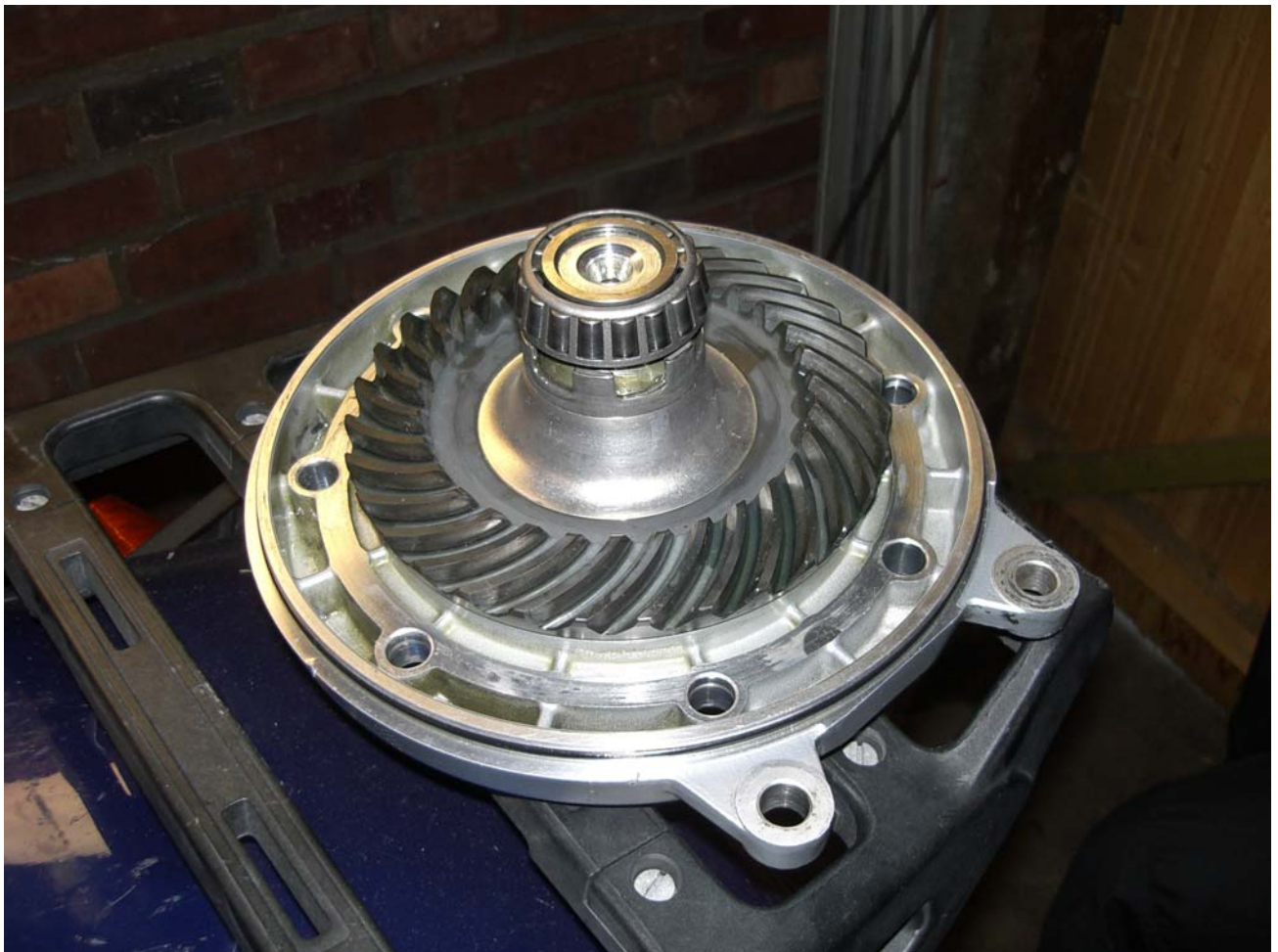
Abbildung 3 Ausgebauter Teil des Endantrieb
