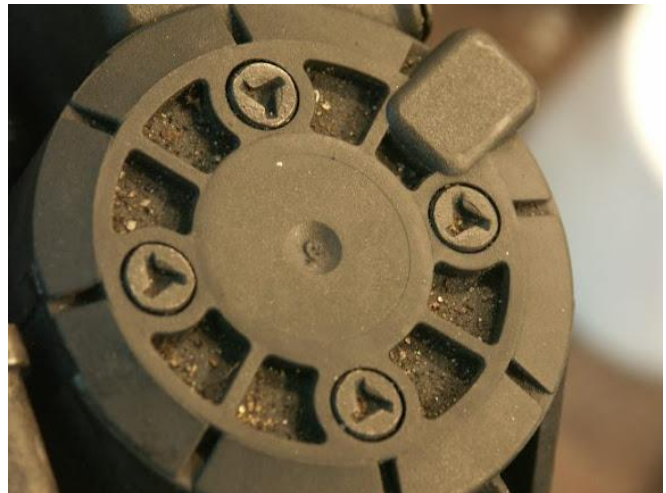
Spezialschrauben am Motor und Modul (TW4 bits)
