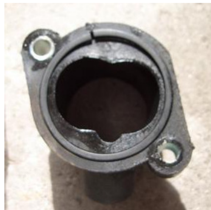
Defekter O-Ring im Drosselklappen-Flansch
