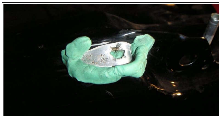
Abb.: 6.2-2 – Knetmasse außen anbringen
