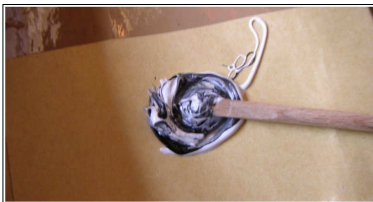
Abb.: 6.2-4 – Beide Komponenten zu gleichen Teilen vermengen
