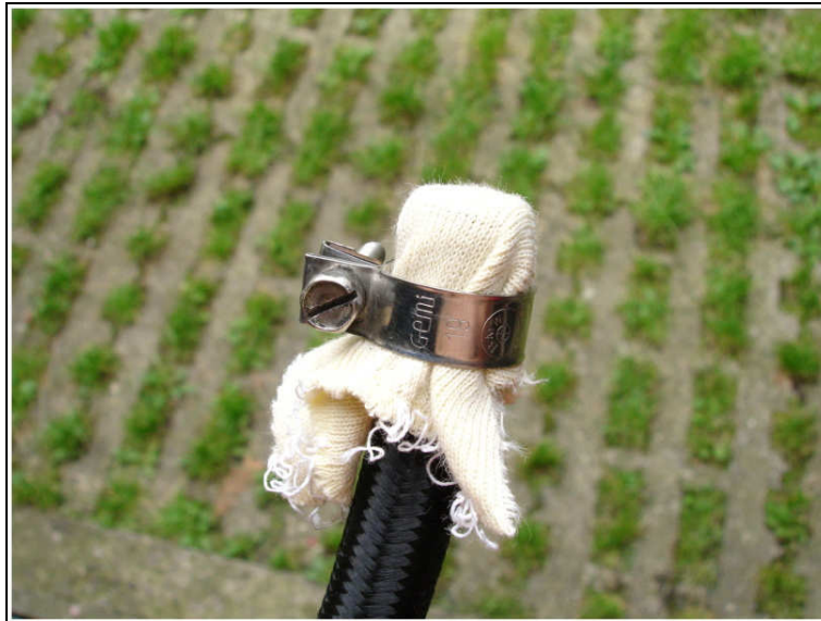
Abb.: 5.2-3 – Kraftstoffsystem während den Arbeiten vor Fremdkörpern schützen
