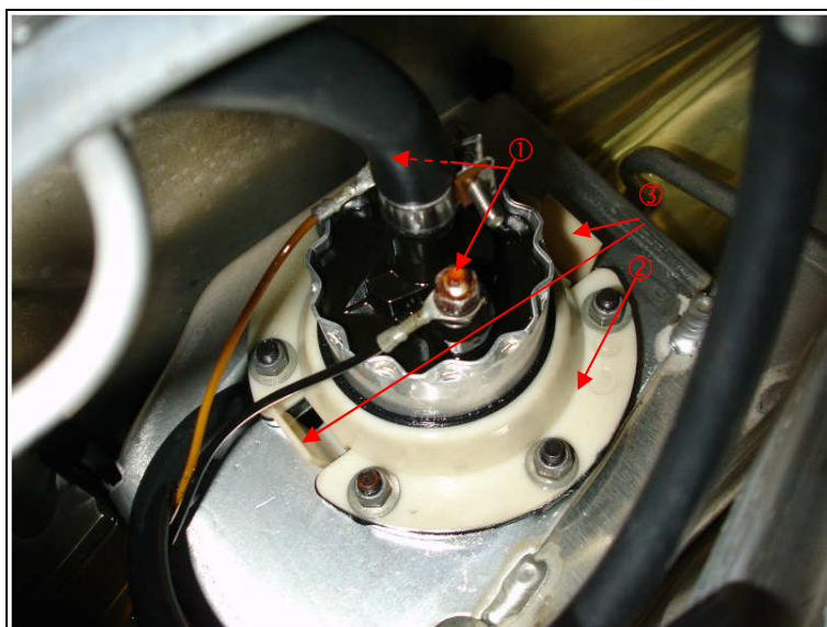
Abb.: 5.3-2 – Kraftstoffpumpe demontieren
