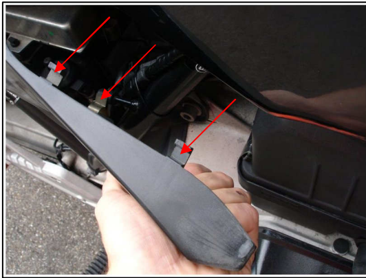
Abb.: 4.3-1 – Seitenteil aus Tankfalz hebeln
