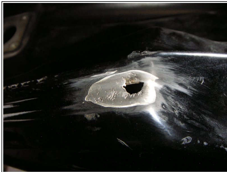
Abb.: 6.1-3 – Tatsächliches Ausmaß der Korrosion
