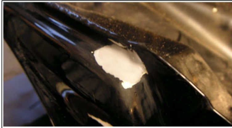
Abb.: 6.3-3 – Mit feiner Schmirgelleinwand die Form vollenden
