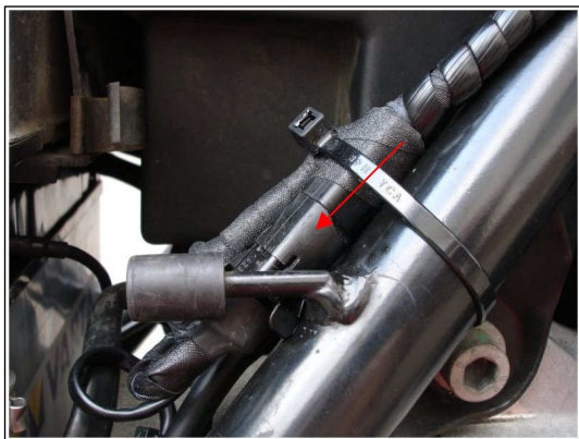
Abb.: 5.2-1 – Steckkontakt Kraftstoffpumpe / Füllstandsanzeige
