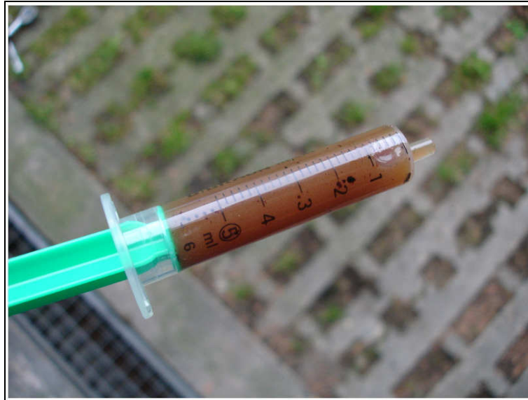
Abb.: 5.4-1 – Schmutzpartikel aus dem Kraftstofftank
