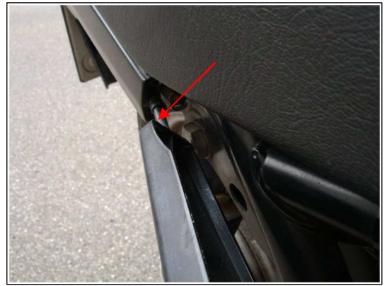
Abb.: 4.3-2 – Seitenteil aus Stifthalterung ziehen
