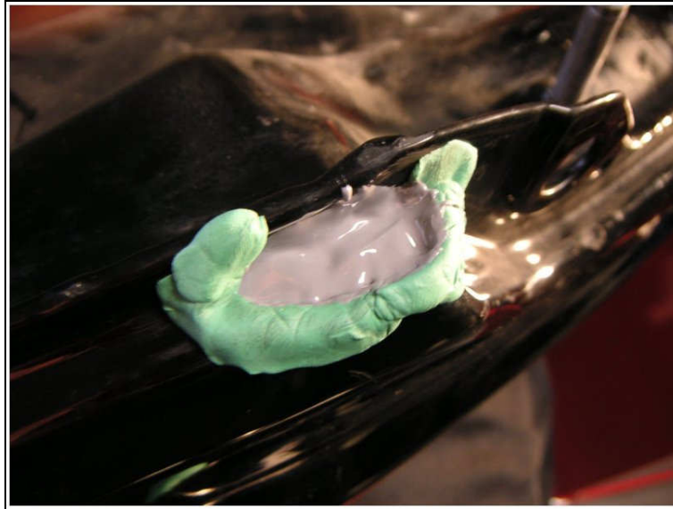
Abb.: 6.2-6 – Epoxyd-Klebstoff auftragen
