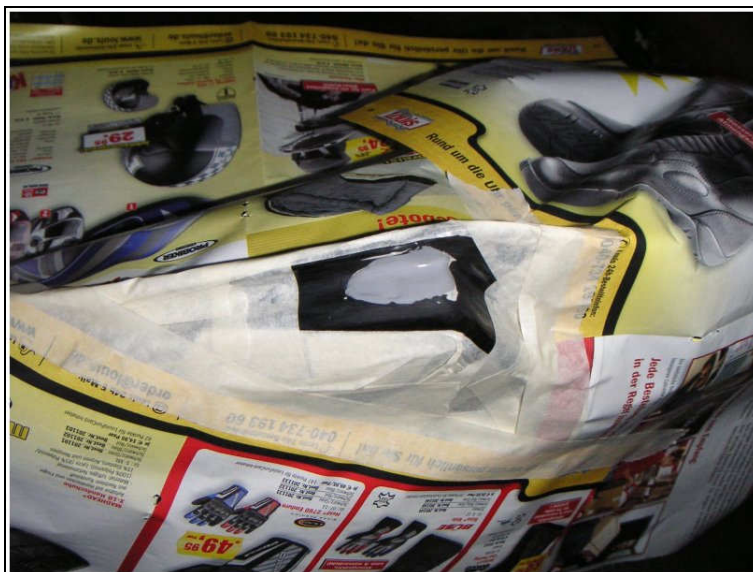
Abb.: 6.3-5 – Abgeklebter Tank, fertig zum Lackieren
