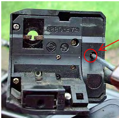
Schraube Kabeleingang lösen
