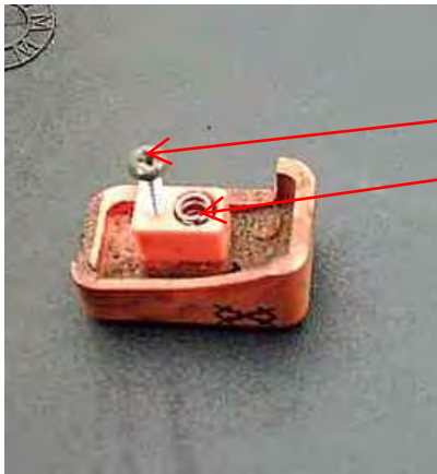
Blinkerrücksteller mit Schraube & Feder
