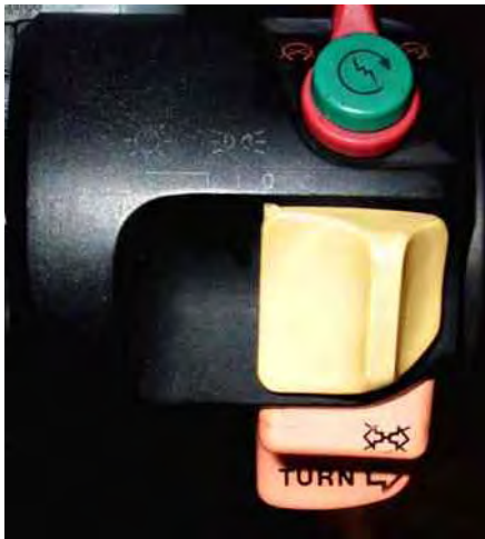
Schalter zuerst auf Funktion prüfen bevor man am Lenker verschraubt
