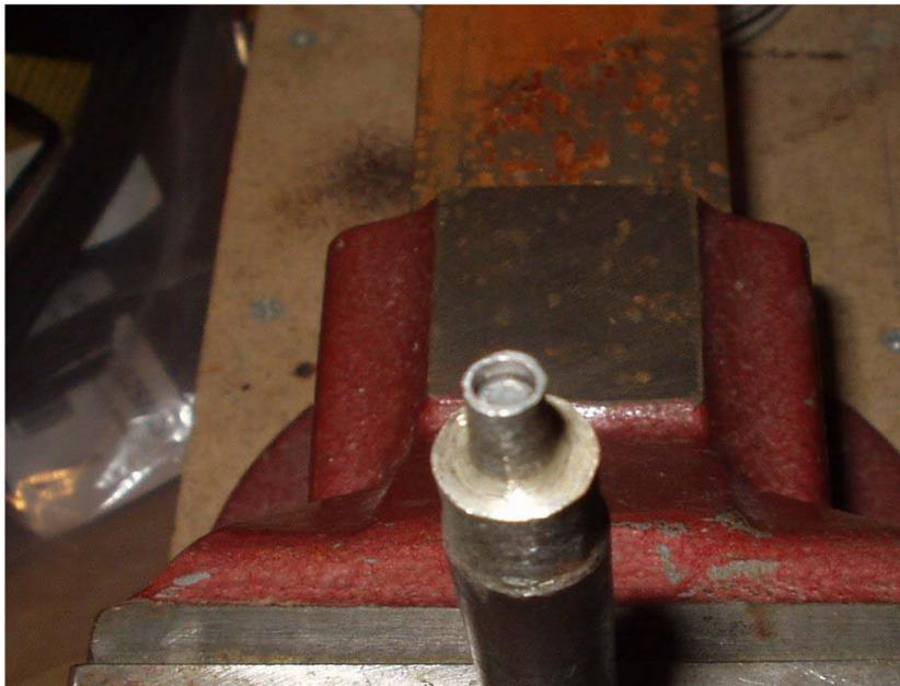
**Nietwerkzeug (Amboss) aus altem Körnerschaft, der mittels Schleifstein in Form gebracht wurde. Bohrung 3,5 mm. In die 10 mm tiefe Bohrung wurde ein Abschnitt von einem Bohrerschaft versenkt, damit sich eine plane Fläche ergibt, auf dem der Nietfuß gut aufliegt. Tiefe danach ca. 1,5 mm.**
