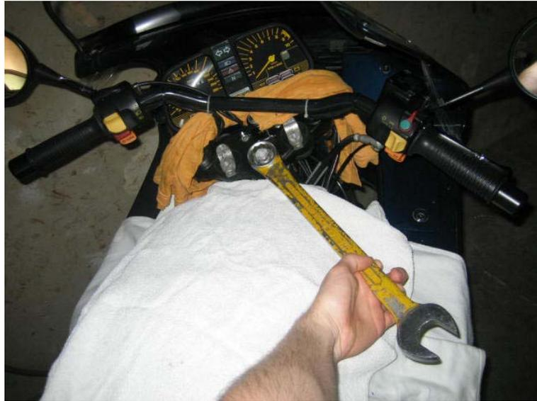
Dann wird das Konterrohr mit 19 mm Sechskant von 2 bis 3 Umdrehungen gelöst.
