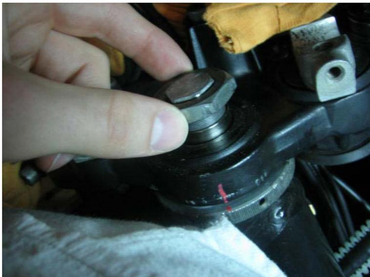
Mit dem 32 mm Ringmaulschlüssel wird der Ring zwischen Sechskantmutter und Einstellring festgeknallt (Mann sieht, daß ich das Konterrohr mit dem 19 mm Ringmaulschlüssel festhalte).
