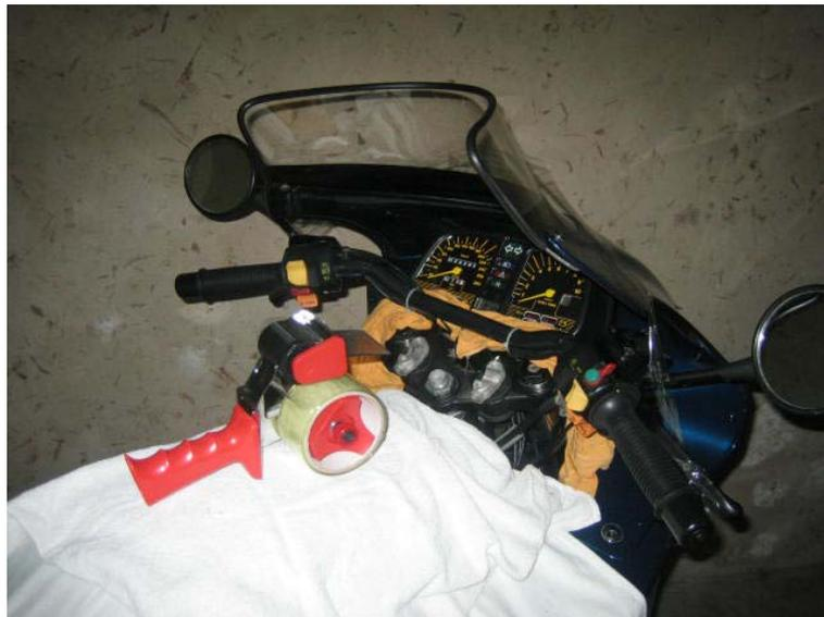
Das Vorderrad wird links auf Anschlag gebracht und die sehr flache 32 mm Sechskantmutter abmontiert (hier der spezielle 32 mm Ringmaulschlüssel, schönes Teil, nicht?)
