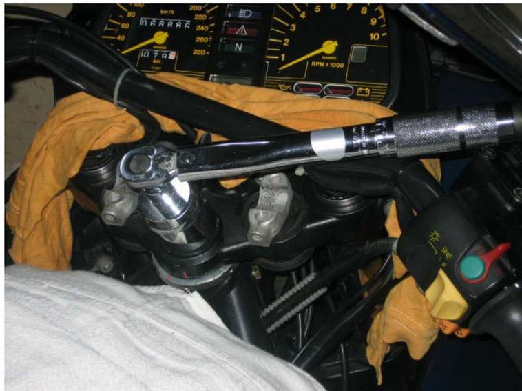
Seht um wieviel der Einstellring sich von seiner Ausgangsposition gedreht hat. Nun den Lenker von Anschlag auf Anschlag mehrmals drehen. So werden die Lager ordentlich positioniert. Ein Weichhammerschlag auf das Konterrohr kann zum selben Ergebnis führen.
