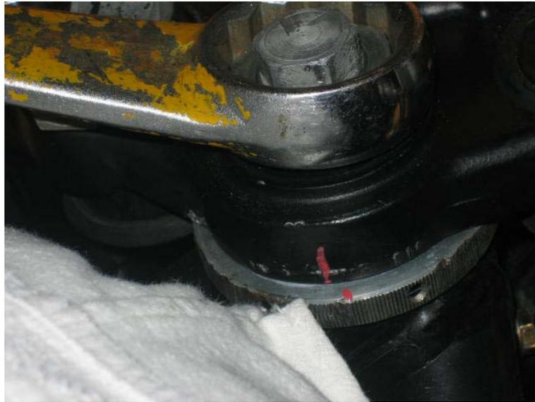
Mit dem Drehmomentschlüssel wird die Sechskantmutter (ja mit der 32 mm nuß!) mit **25 mN** fest geknallt. So werden die Lager unter Druck gestellt. So wird sicher gestellt daß sie kein Spiel haben. Der Einstellring dreht sich mit? Ja das ist normal, so soll es auch sein.
