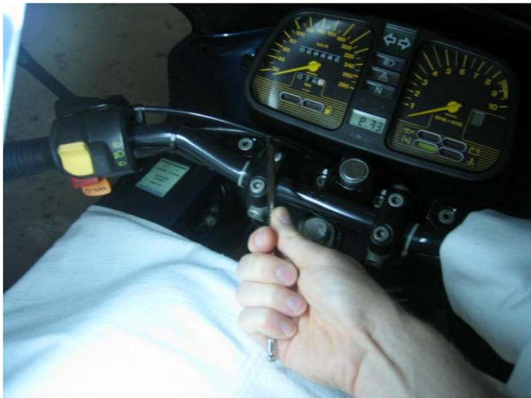
Die Position des Lenkers braucht nicht notiert zu werden (mit z.B. unlöslichen Lack wie es Bozo-der-Clown-Mechaniker es früher an meinem Motorrad machte). Es gibt einen Körnerpunkt rechts von der linken Lagerbock-Klemmhälfte. Er muß sichtbar sein und mit der Außenfläche des Lagerbocks fluchten .
