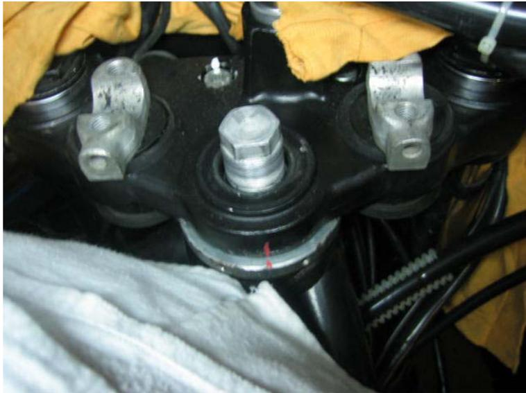
Hier ist eine Kopie des von BMW Seiten empfohlenem Ring. Teilenummer 90.88-6 314 890 (ID 22, AD 24.55 und L 10 mm). Mein Exemplar habe ich aus Stahl auf einer Drehbank gemacht. Er ist mit einer 5 Micronmeter Nickelschicht überzogen (damit er schön aussieht und nicht rostet; diese Gelegenheit hatte ich bei der Arbeit; ansonstens wär' das Teil stinknormal; bin halt pedant :-).
