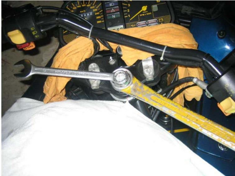
Hier eine Nahaufnahme: seht wie der Ring zwischen Sechskantmutter und Einstellring entlang des Konterrohrs fesgehalten wird. Diese vier Teile bilden nun nur noch eine Einheit.
