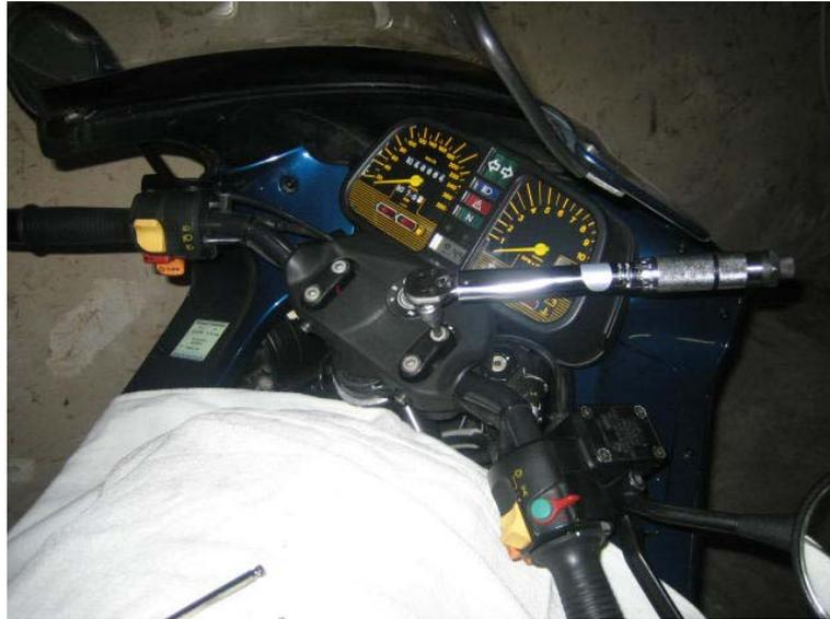
Die Lagerböcke der Tauchrohre der oberen Gabelbrücke werden mit  $14.9\pm 0.2$  mN festgeschraubt.
