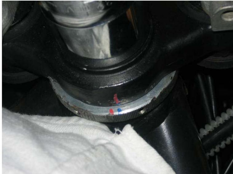
Jetzt wird wieder die Sechskantmutter abmontiert. Achtung die Position des Einstellring im Bezug zur oberen Gabelbrücke darf sich nicht mehr verändern (die rote und blaue Marke müssen immer noch fluchten = keine Bewegung des Innenring des oberen Kegelrollenlagers).
