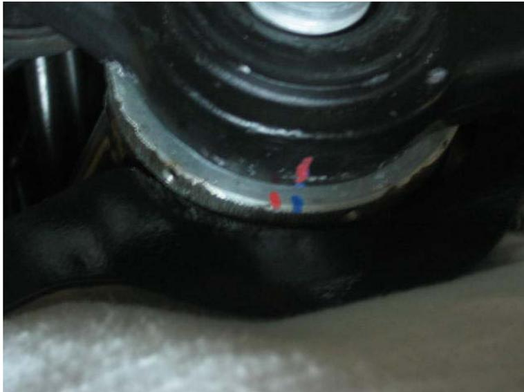
Lenker auf Anschlag rechts, das Konterrohr wird auf  $65\pm 5$  mN fest gedreht.
