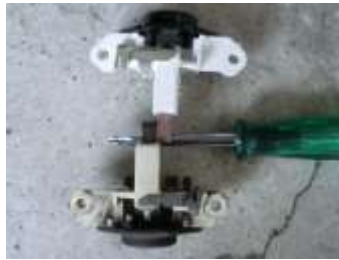
Hier einmal die Unterschiede zwischen altem und neuem Regler
