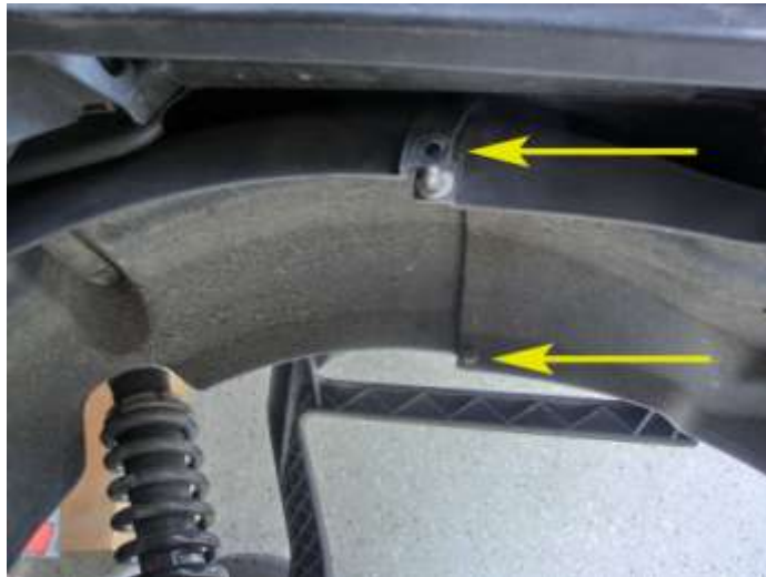
Diese 2 Schrauben lösen und den Kotflügel nach vorne / unten heraus drehen.
