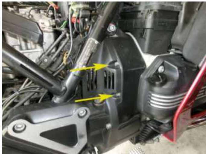
2 Schrauben lösen und Abdeckung herausnehmen.
