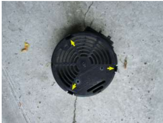
Nun noch mal die Abdeckung einzeln mit Schraubenlöcher und den markierten Stellen mit den Klipsen.
