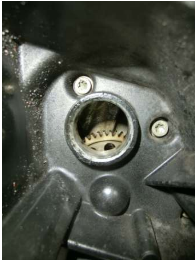
Hier das Loch, wo das Zahnrad des Starters in ein anderes Zahnrad greift.
