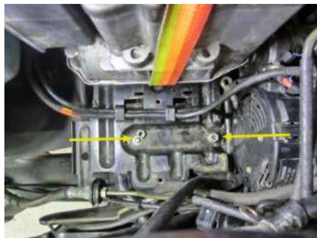
Auf der Batterieträgerplatte insgesamt 4 Muttern lösen. Hier diese beiden....
