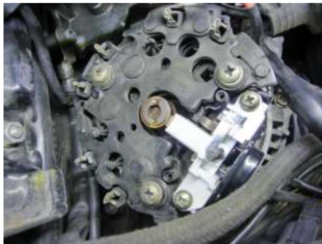
Hier nun die LiMa mit neuem Regler. Anschließend den Plastikdeckel der LiMa wieder draufstecken und verschrauben.
