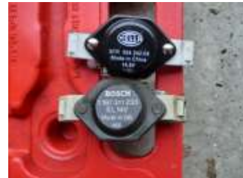
Hier einmal die Unterschiede zwischen altem und neuem Regler
