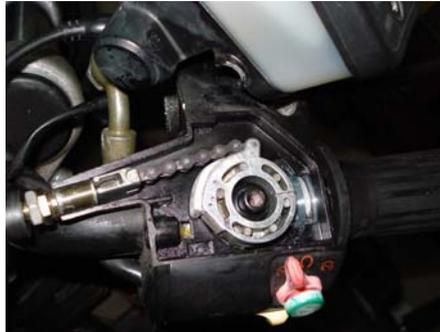
Das geht am Besten durch Aufbringen eines Alu-Keils. Dieser Keil vergrößert den wirksamen Umschlingungsradius der Kette sodass für den gleichen Seilzugweg ein kleinerer Drehwinkel ausreicht.
