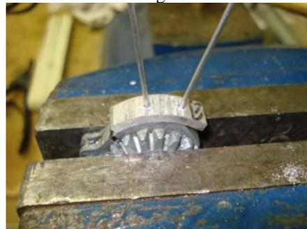
Aus 3mm Alublech ca 25mm x 8mm ausschneiden und durch Biegen genau anpassen.
