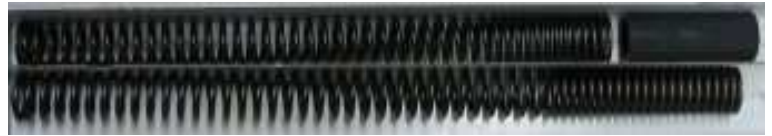
Bild 11 Vergleich Original mit Kunststoffhülse und Wilbers – Feder (Die Länge ist identisch)
