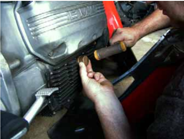
Bild 7 Mit einer Nuss o.ä. das Glas ins Gehäuse treiben
