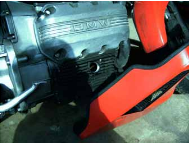
Bild 5 Öl mit fusselfreiem Tuch entfernen
