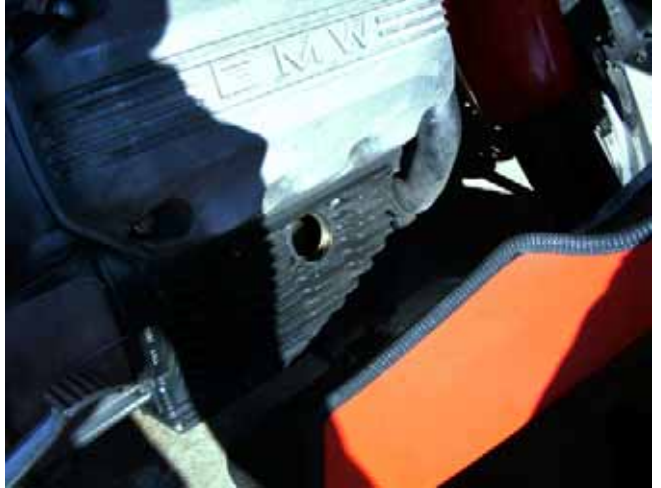
Bild 4 Nur etwas Öl auf dem Fräsrand
