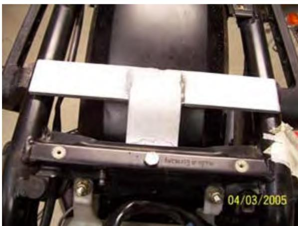
Löcher in Platte gebohrt, damit die Grundplatte auch an den Rahmen geklemmt werden kann.
