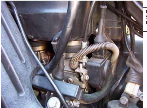
Der schwarze Kasten mit dem Stecker obendrauf ist der Drosselklappenschalter
