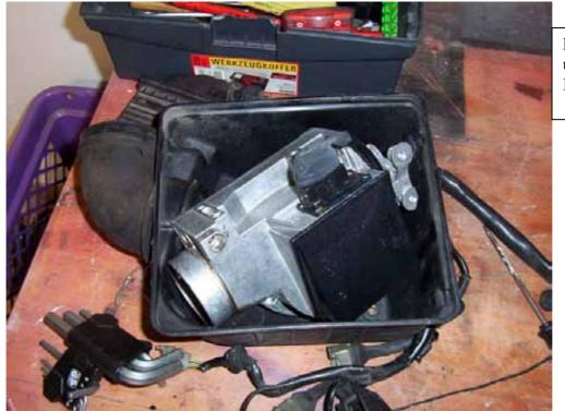
Der LMM sitzt im Luftfilterkasten um dort hinzukommen muss der Kasten ausgebaut werden
