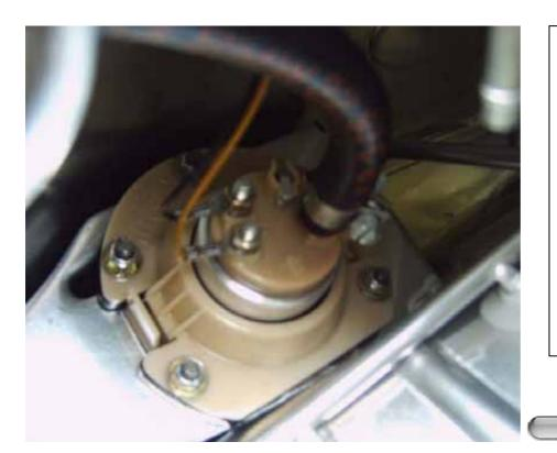
Die Benzinpumpe sitzt im Tank. Bei der gezeigten Pumpe handelt es sich um die Version von VDO. Es gibt auch noch eine von Bosch diese ist etwas größer und hat eine andere Halterung. Um an die Pumpe ranzukommen oder den Spritfilter zu wechseln muss der Einfüllstutzen am Tank ausgebaut werden.
